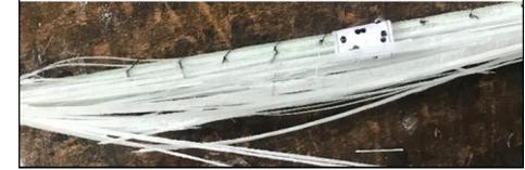
*Photo d'un échantillon après rupture en traction*
