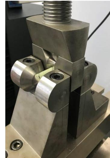
*Essai de cisaillement interlaminaire*
