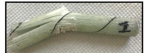
*Eprouvette après essai de cisaillement interlaminaire*
