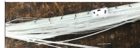
Photo d'un échantillon après rupture en traction
