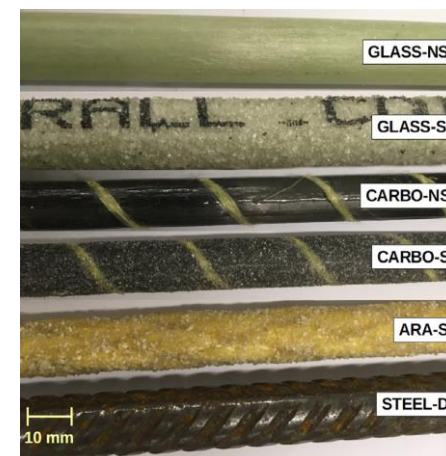
Photo de différentes armatures (Rolland, 2015)
