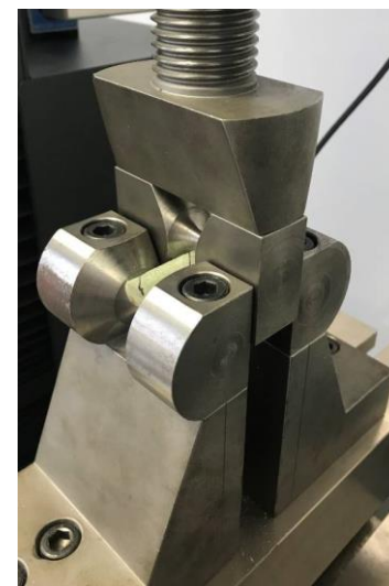
Essai de cisaillement interlaminaire
