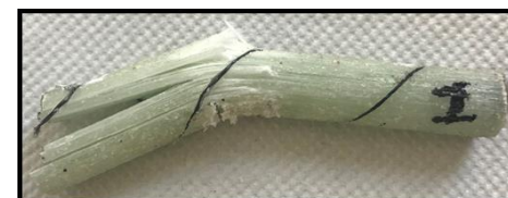
Eprouvette après essai de cisaillement interlaminaire
