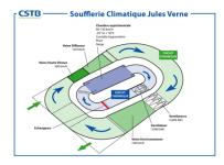
La soufflerie climatique Jules Verne a été conçue pour étudier à l'échelle de la vraie grandeur, les effets combinés du vent et des autres paramètres climatiques (pluie, sable, soleil, température, neige, ...) sur des éléments de construction, des véhicules ou du matériel de transport, ou sur tout système soumis à des conditions climatiques de type extrême.
